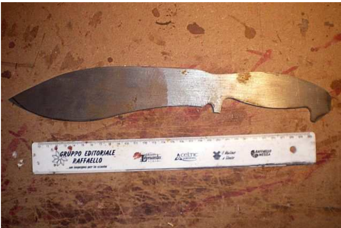
A questo punto ritaglio la sagoma dall' acciaio con una sega a nastro. Now I'm ready to cut the shape in the steel with a bandsaw.
