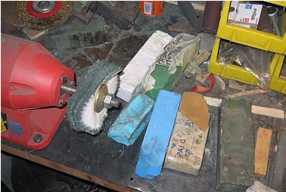
Infine lucido il manico con una ruota di stracci e paste lucidanti. Polishing with some compounds.
