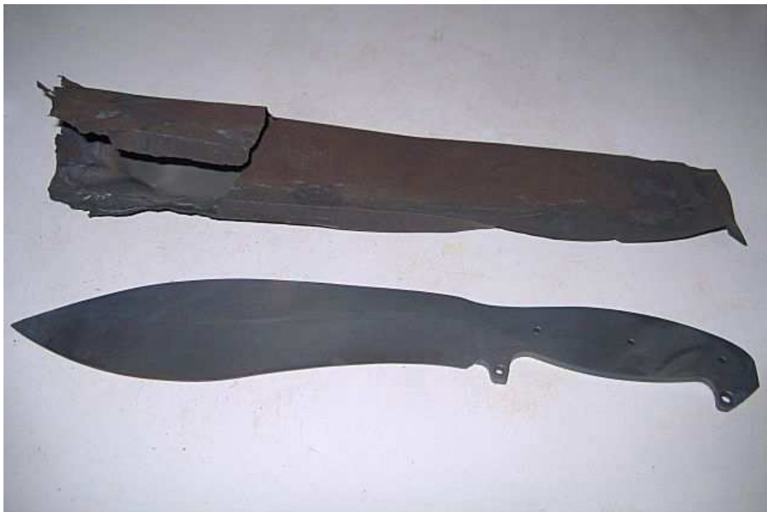
Ecco come si presenta la lama alla fine della tempra. The blade after the heat treatment
