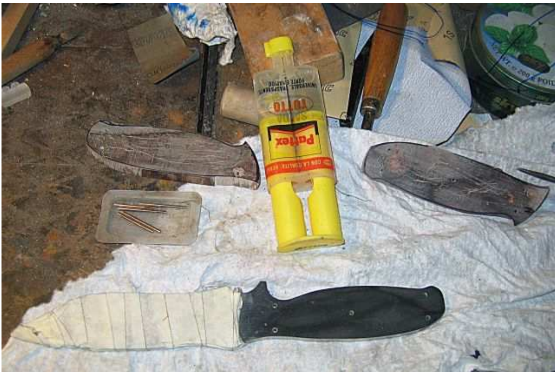
Sgrasso accuratamente tutte le parti che dovrò incollare, e verifico di avere tutto l'occorrente a disposizione sul tavolo.
