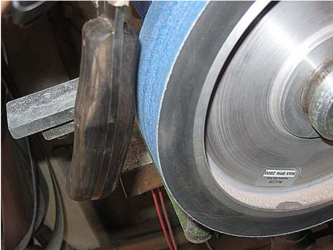
Carteggio il manico dandogli la forma voluta. Shaping the handle with a beltsander
