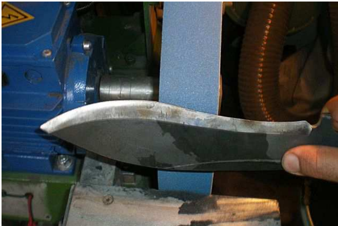
Ora creo il bisello vero e proprio fino all' altezza che avevo stabilito inizialmente. Comincio a togliere materiale partendo dal margine superiore del "mini-bisello" creato nella fase precedente.
