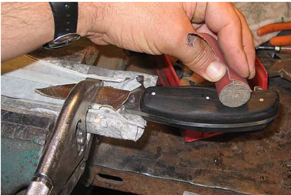
Continuo con carta vetrata a mano per correggere alcune imperfezioni e lucidare il manico utilizzando carte con grane sempre più fini. Finishing by hand using thinner sandpaper.
