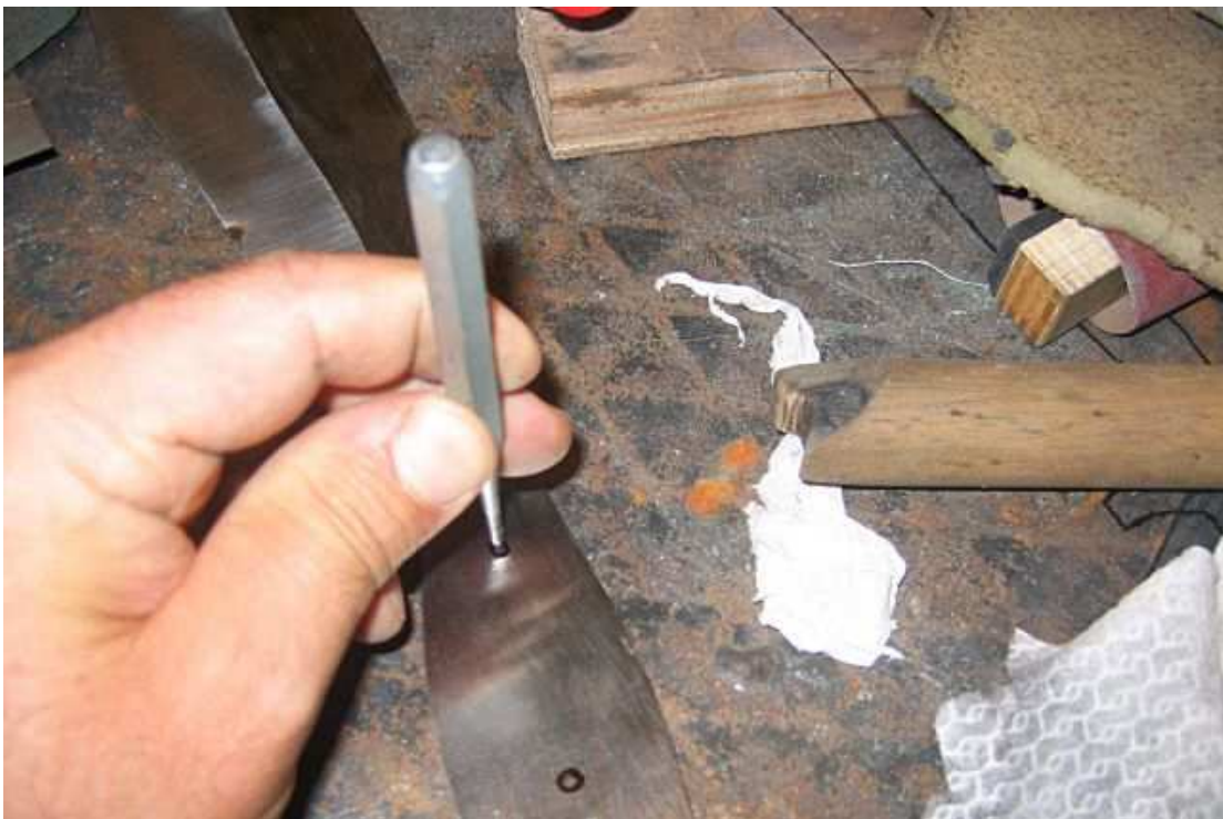
Punzonatura e fori per i rivetti del manico. Punching and drilling for the handle rivets.
